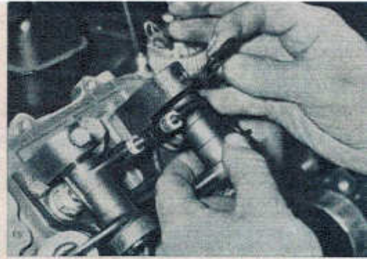
Oben: Um ein Spiel der Kipphebel zu ermöglichen, diese aber stets in der richtigen Lage zu halten, sind zwischen Lagerbock und Kipphebel dünne Spiralfedern vorgesehen.
