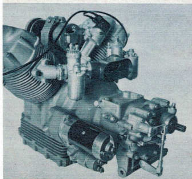
V 7-Motor mit Getriebe aus dem Rahmen ausgebaut. Die Zylinder stehen in einem Winkel von 90° zueinander. Zylinder und Zylinderköpfe aus Leichtmetall, hartverchromte Zylinderlaufflächen. Bohrung/Hub 80/78 mm. Verdichtung 9,0. Vergaser-Ø 29 mm. Zweischeiben-Trockenkupplung, Elektro-Starter. Vier Gänge. (Siehe Leistungskurve — links unten — und Gangdiagramm — rechts unten). Luftfiltration durch Papier-Feinstfilter.
